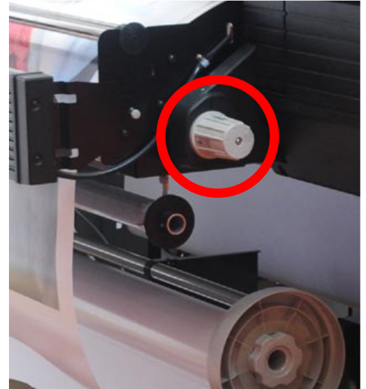
En la parte frontal y trasera de la impresora hay una perilla de control de presión que ajusta los rodos de presión. en cuatro posiciones: alto, normal, bajo y abierto.
