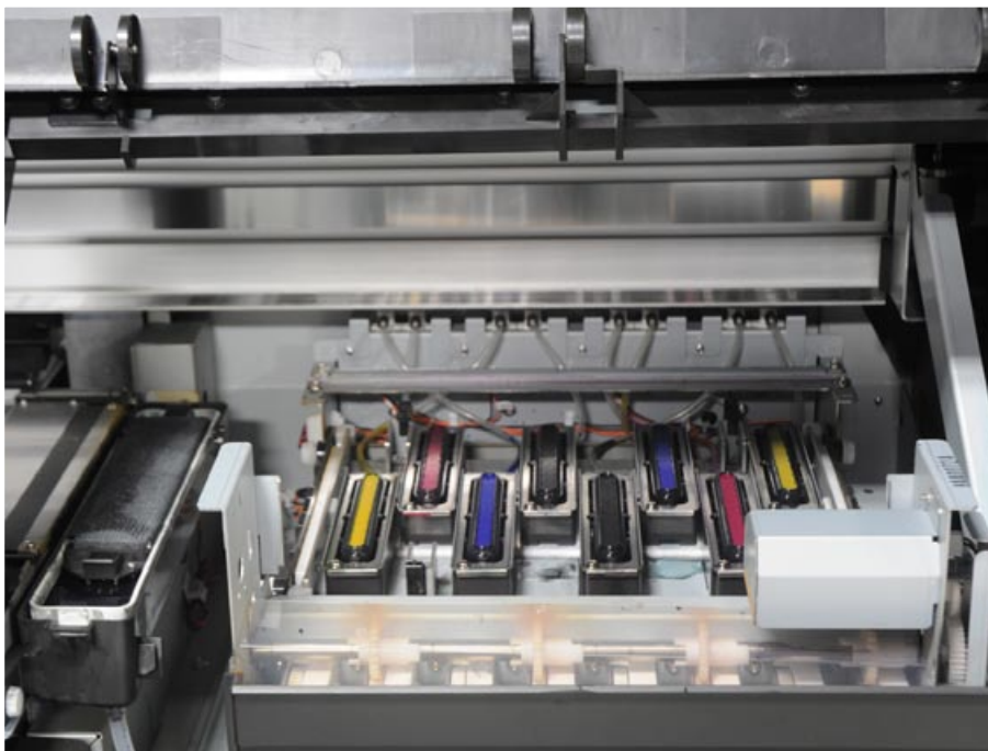
Al lado derecho se encuentra la estación de nivelación, donde está el área de nivelación, quien previene que las boquillas de los cabezales se sequen.
