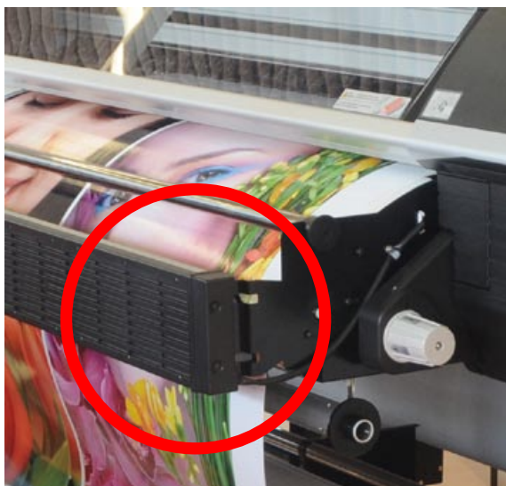
Al frente después del área de la platina, se encuentra el calentador frontal que seca la tinta para estabilizar la calidad de la impresión.
