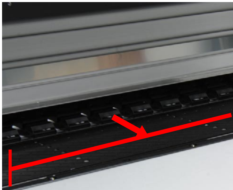
El sistema de succión atrae el material hacia la platina.
