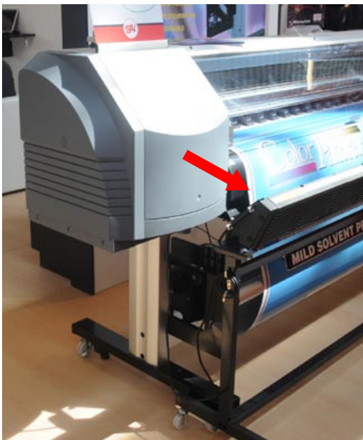
La impresora incluye un soplador adicional para facilitar el secado del material.
