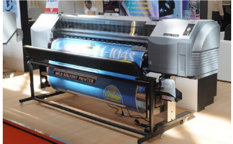
La estructura es una mezcla de plástico y metal que le da a la impresora una estructura sólida y a la vez liviana
