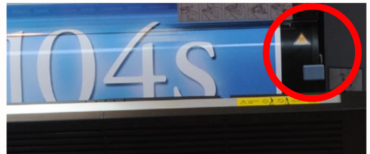
Es posible ajustar la presión de los rodos: sin presión, presión débil, o presión normal; empujando o halando la palanca de presión
