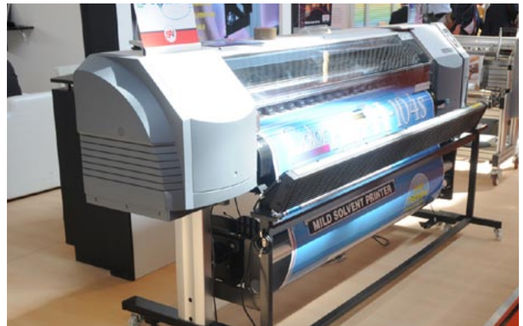
La estructura es una mezcla de plástico y metal que le da a la impresora una estructura sólida y a la vez liviana
