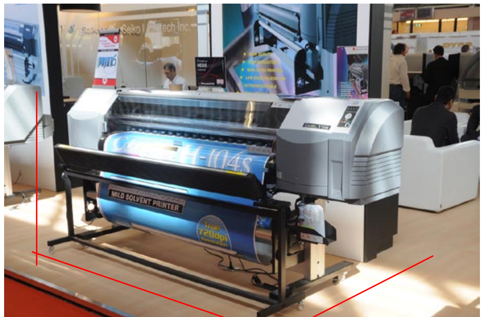
Es necesario un espacio alrededor y de soporte de 3.65 m. (144")(ancho) x 3.83 m. (150") (profundidad) x 1.80 m. (71") (altura) para la instalación.
