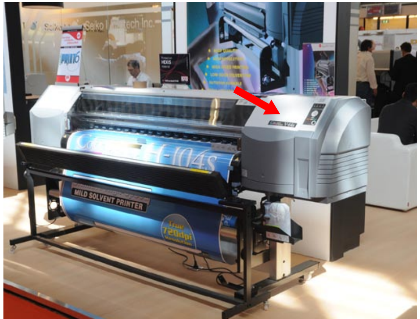
En la parte frontal derecha de la impresora se encuentra la pantalla LCD, donde el operador puede controlar la mayoría de las opciones de impresión.
