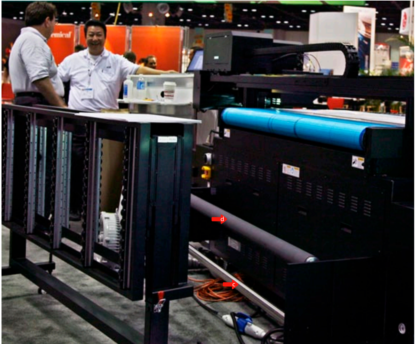
Rear view. Spindle (c) and tension bar (d)
