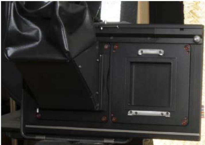
Figura 2. Adaptador Cambo, en la imagen aun no se ha colocado el respaldo digital. Foto: E.Sacayón
