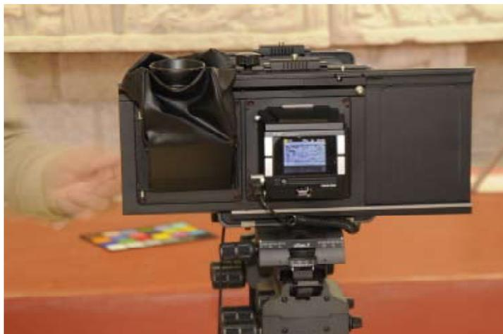
Figura 4. El respaldo digital Phase One P25+ ha sido puesto en el adaptador Cambo para cámaras de formato amplio.
