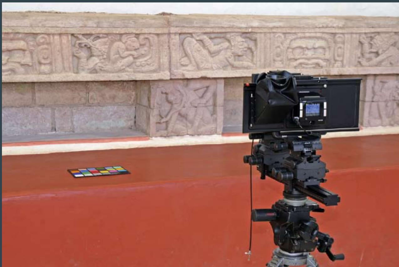
Figura 1. Cámara Cambo de formato amplio con un adaptador para respaldos digitales. Respaldo Digital: Phase One P25+. Tripode y cabeza para tripode marca Bogen. Foto: E.Sacayon
