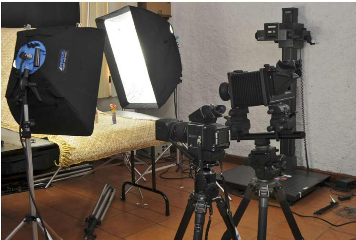
Figura 5. La primera cámara a la izquierda es una Hasselblad ELX con el respaldo digital Phase One P25+. La cámara a la derecha es de formato amplio y es una Cambo con un adaptador para formato medio.
