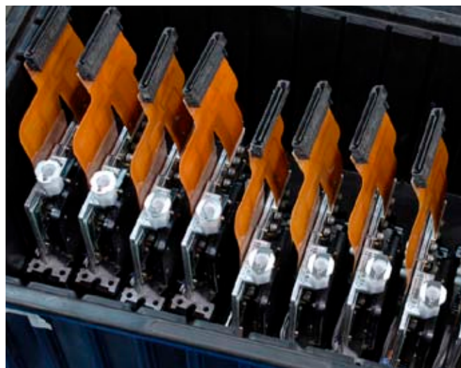
печатные головки подготовлены для установки в VUTEK 320/400 FC+. VUTEK визит на фабрику, 2008.
