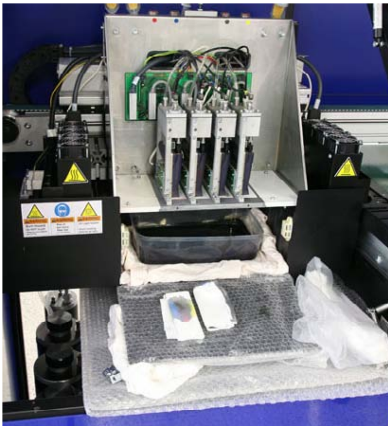
Во время пужа чернил, они попадают в специальную капельницу, расположенную под печатной каретки на станции техобслуживания. На фото- принтер первого поколения Grapto Octopus.
