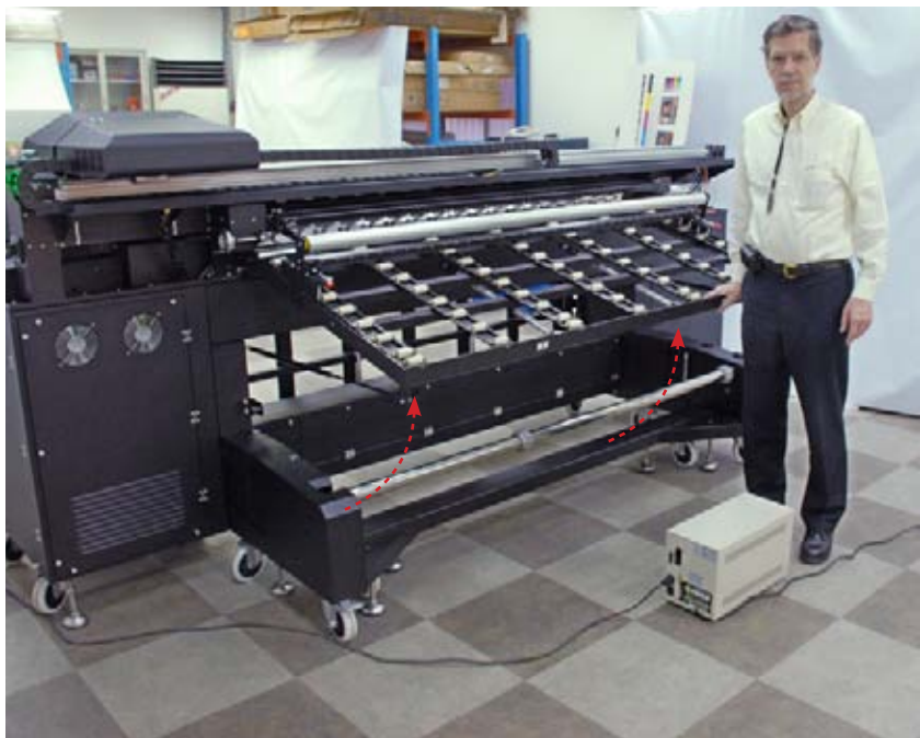
The GCC StellarJet 183uv - гибридный принтер. Вы видите, что стол поднят для печати на плоских материалах. Но он модифицируется и для рулонных носителей.
