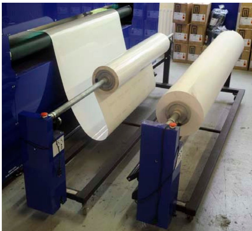
На фото шпиндель УФ-принтера Grapo Octopus. В некоторых случаях система загрузки материала скрепена с каркасом принтера. Но в Grapo Octopus the feeding шпиндель-та деталь, что может быть демтирована.
