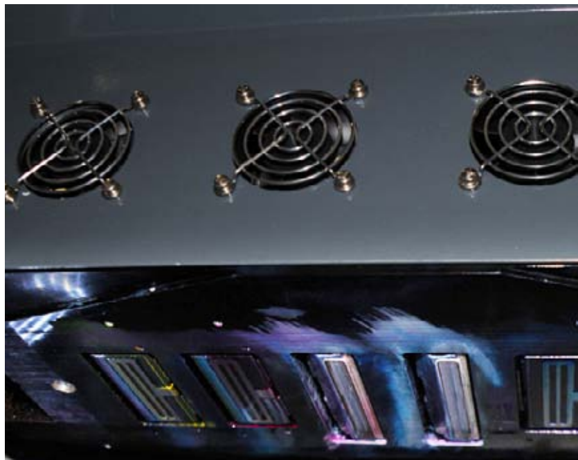
На фото- печатная каретка снизу. Во время того как печатные головки находятся в вертикальном положении-негативное давление не дает чернилам вытекать.
