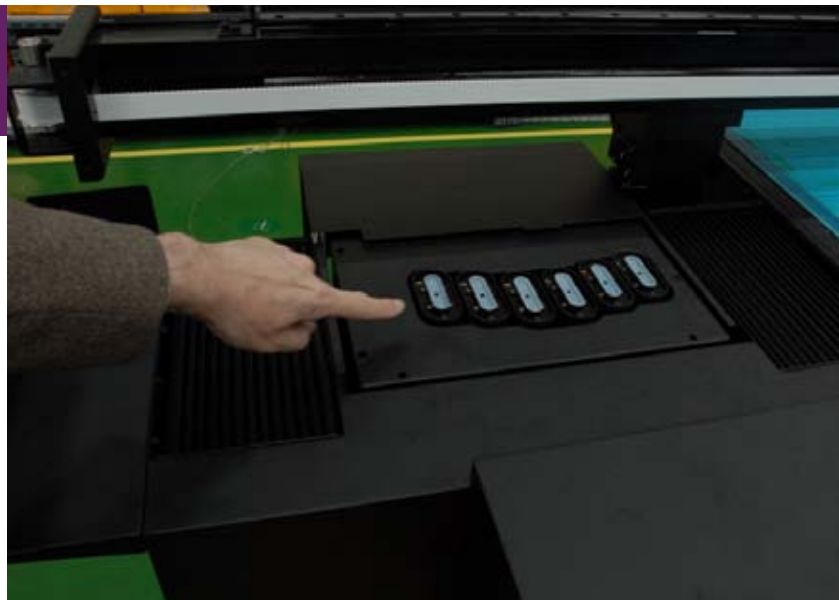
Капы в Dilli Neo Titan. Головки закрываются при опускании каретки. посещение фабрики Dilli, 2008
