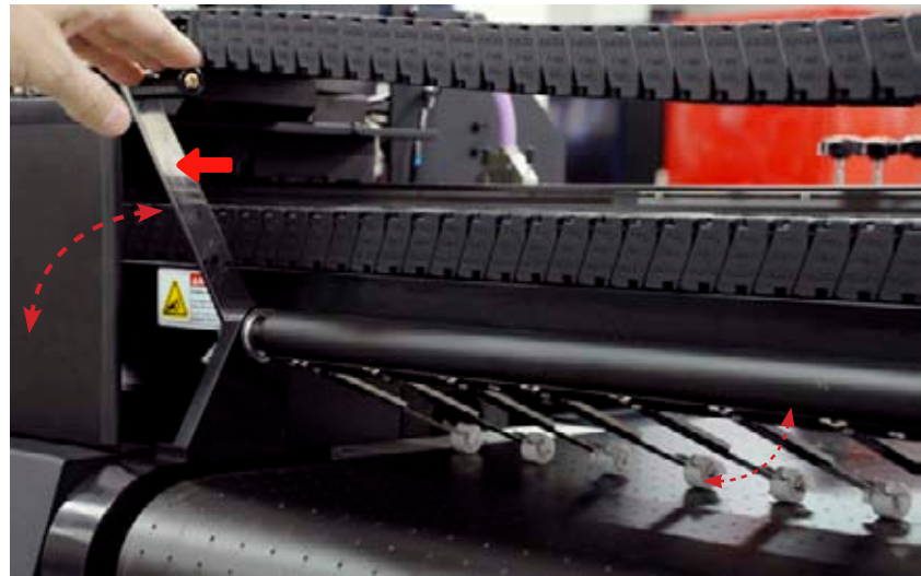
Пример прижимных роликов на комбопринтере IP&I 1606 CUBE UV. Прижимные ролики могут быть подняты или опущены, но в некоторых принтерах это процесс регулируется компьютером.
