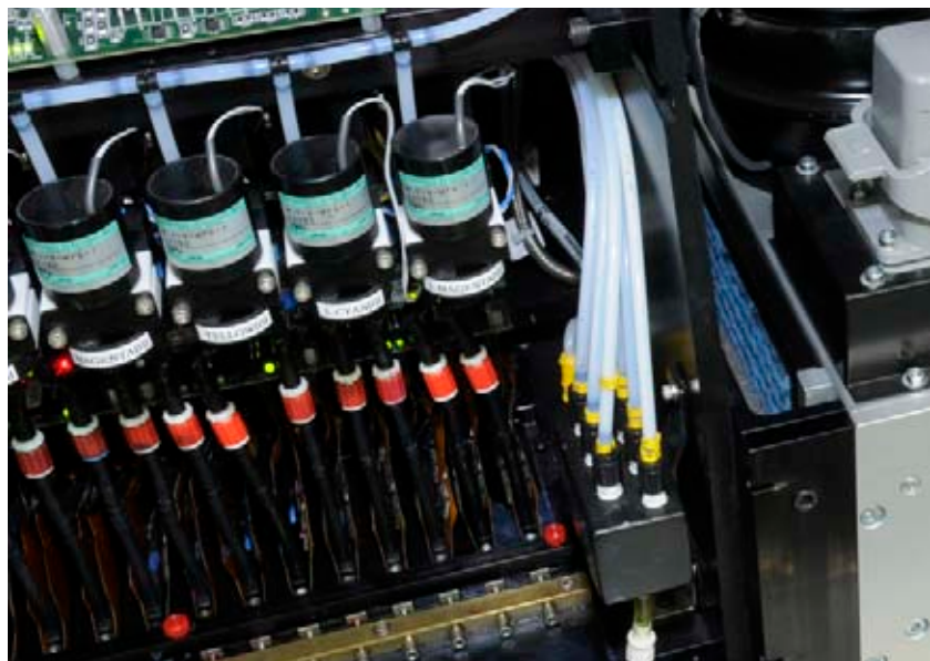
Так выглядят резервуары для чернил в планшетном УФ-принтере.
