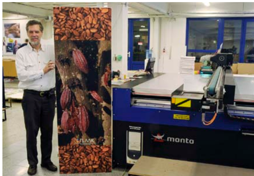
Твердые материалы- специализация УФ-принтеров. Доктор Хельмут держит деревянную дверь напечатанную с помощью планшетного УФ принтера Grapo Manta.
