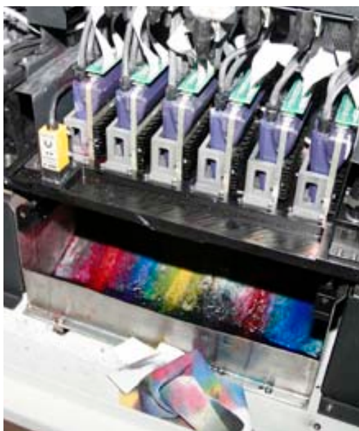
Отработанные чернила собираются по капле а затем попадают в емкость для отработанных чернил а затем попадают в емкость для отработанных чернил УФ-принте Teckwin TeckSmart 1600.
