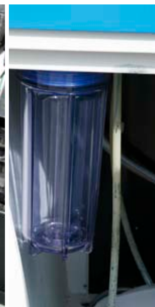
Отработанные чернила собираются по капле а затем попадают в емкость для отработанных чернил а затем попадают в емкость для отработанных чернил УФ-принте Teckwin TeckSmart 1600.
