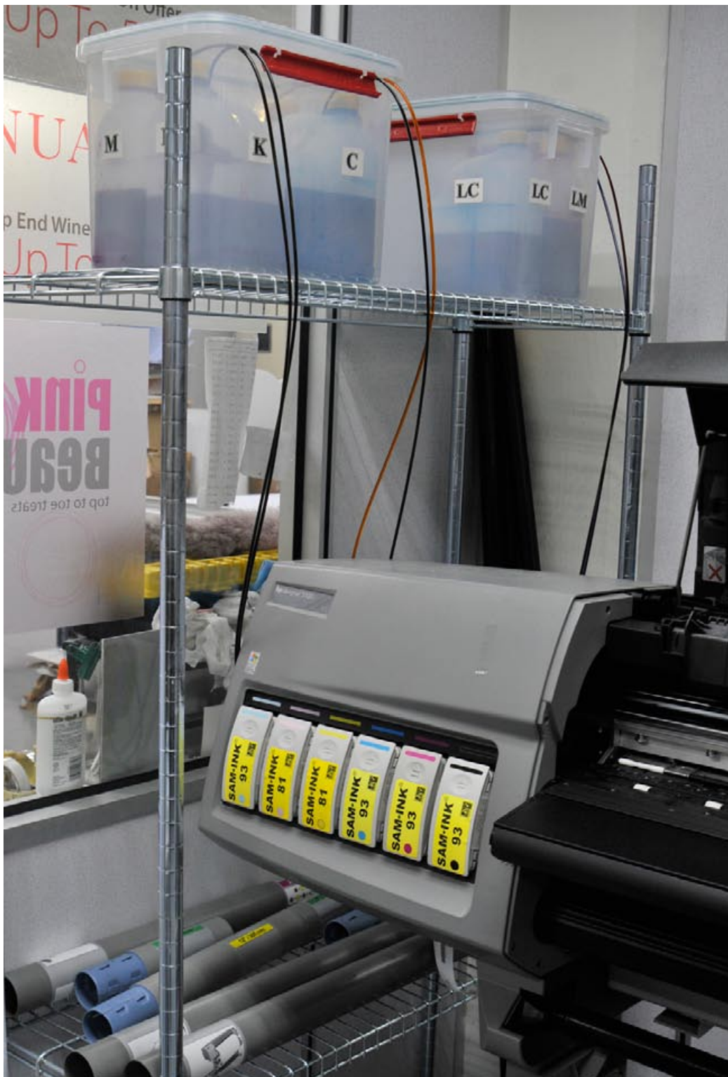
Здесь вы можете видеть Систему Непрерывной Подачи Чернил из банок в принтере HP Designjet.
